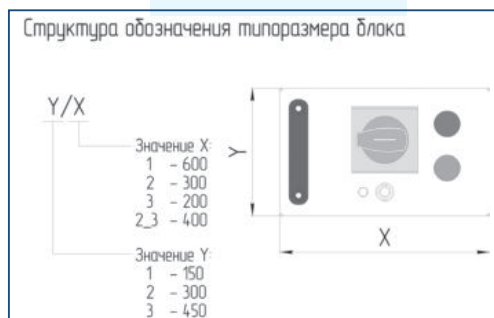
Рисунок 1.2 - Обозначение типоразмера выдвижного блока, применяемого в ЩСУ
